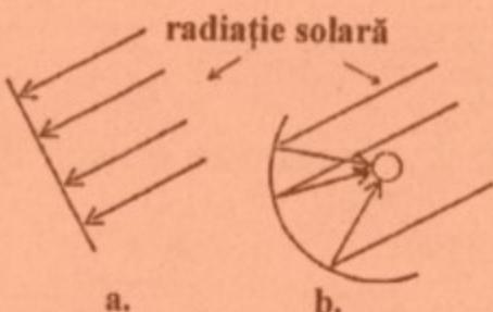
**Fig. 6.18 Principalele tipuri de captatoare solare:**
