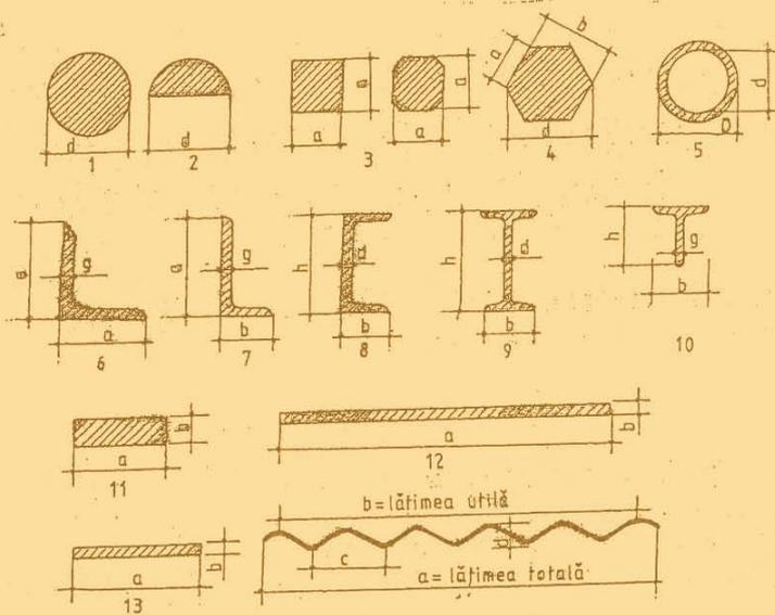
Fig. 1.1. Tipuri de profile din oțeluri laminate: 1. oțel rotund; 2. oțel semirotund; 3. oțel pătrat; 4. oțel hexagonal; 5. țevi din oțel fără sudură laminate la cald; 6. oțel cornier cu aripi egale; 7. oțel cornier cu aripi inegale, în L; 8. oțel U; 9. oțel I (dublu T); 10. oțel T; 11. oțel lat; 12. tablă groasă; 13. oțel platbandă; 14. tablă ondulată.
